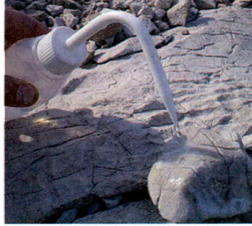
b - Test d'effervescence à l'acide chlorhydrique*.
